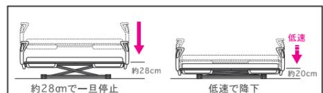
ベッドの高さをさげるときにベッドのフレームに足や物を挟まないように、ボトムの高さが約28cmになるとブザーを鳴らして一旦停止します。その後再び降下ボタンを押すと、ブザーを鳴らしながら最低位 (20cm) まで通常よりゆっくりとさがります。
